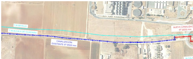
Imagen 1: Captura del Plano n.º 7 donde se indica el trazado de la canalización existente en la que se ubicará la nueva LSMT.
